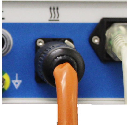
Фигура 9: Включете кабела на нагревателя в букса
