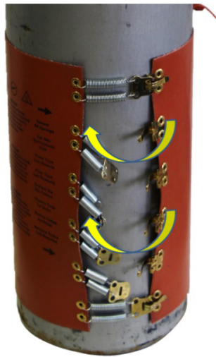
Фигура 8: Обезопасете всички опъващи пружини
