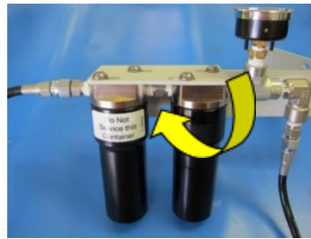
Фигура 23: Премахване на корпуса на филтъра
