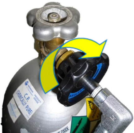
Фигура 5: Закачете черния винт към омрежената връзка
