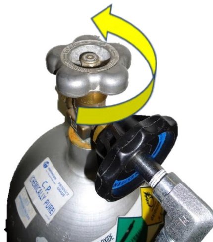
Εικόνα 6: Γυρίστε τη βαλβίδα αριστερόστροφα για να την ανοίξετε
