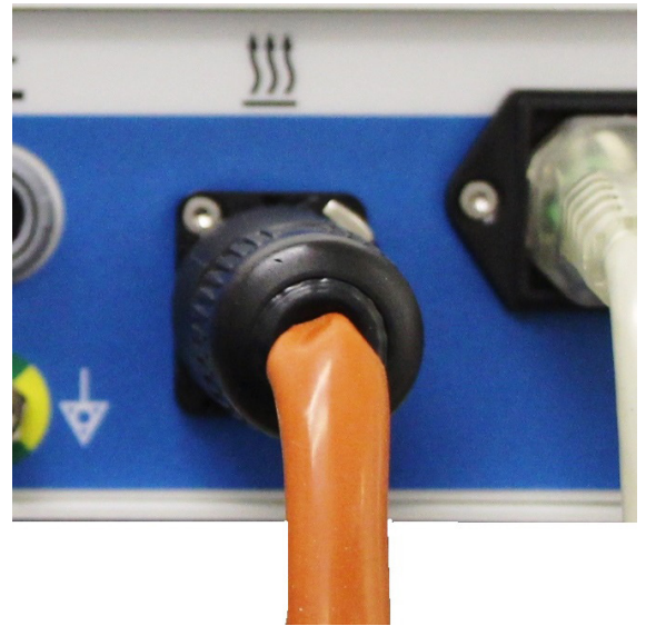
Εικόνα 9: Συνδέστε το καλώδιο της θερμαντικής ταινίας στην υποδοχή
