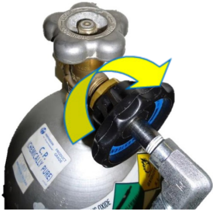
Joonis 5. Musta nupu kinnitamine keermestatud ühendusele
