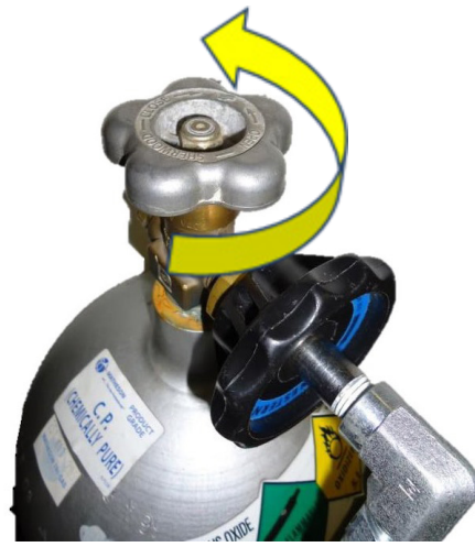
Joonis 6. Ventili avamine seda vastupäeva keerates
