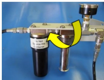
Joonis 24. Desikantfiltri padruni eemaldamine
