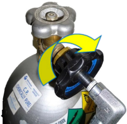
Slika 5: Pričvršćivanje crne spojnice na priključak s navojem
