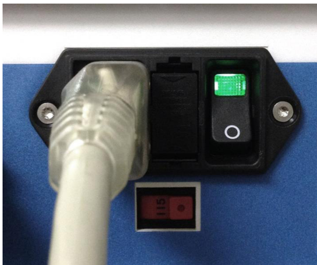
Slika 10: Uključivanje jedinice AtriCure cryoICE BOX s pomoću prekidača
