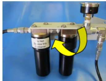
Slika 23: Uklanjanje kućišta filtra
