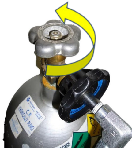
6 pav. Kad atidarytumėte, sukite čiaupą prieš laikrodžio rodyklę
