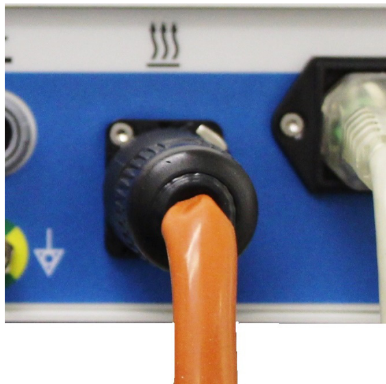
9 pav. Įjunkite šildytuvo juostos laidą į lizdą
