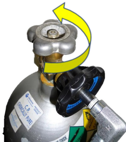
6. attēls Pagrieziet vārstu pretēji pulksteņrādītāju kustības virzienam, lai atvērtu
