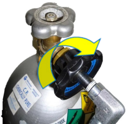
Obrázok 5: Pripojenie čierneho regulátora k závitovej prípojke
