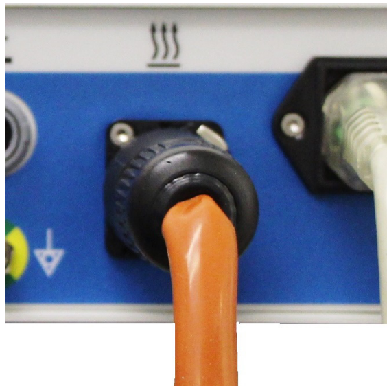
Slika 9: Kabel grelnega pasu priključite na vtičnico
