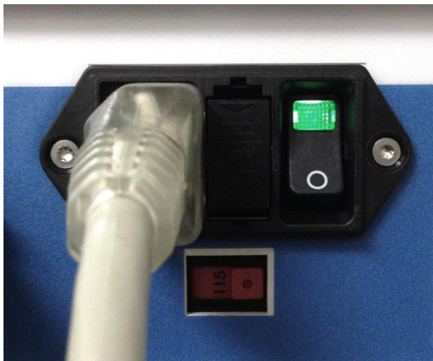
Slika 10: Vklopite enoto AtriCure cryoICE BOX s stikalom
