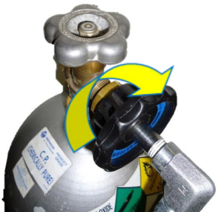
Slika 5: Priključite črn gumb na navojni priključek
