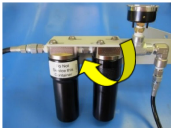
Slika 23: Odstranitev ohišja filtra
