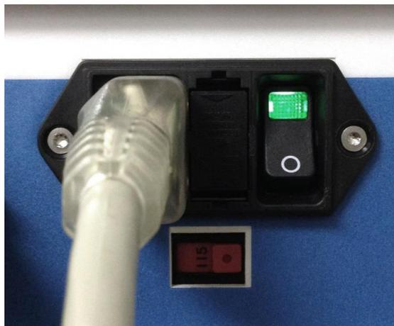
Abbildung 11: Einschalten des AtriCure Cryo Moduls mit Schalter
