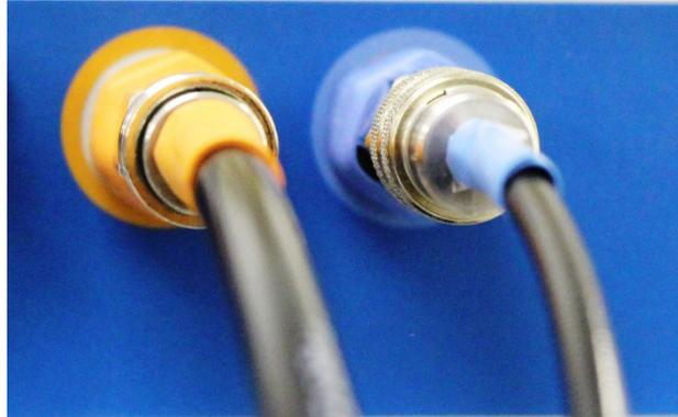
Abbildung 14: Farbkodierte pneumatische Stecker
