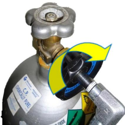
Abbildung 6: Schwarzen Knopf am Gewindeanschluss anbringen
