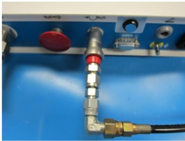
Abbildung 5: N<sub>2</sub>O-Einlassanschluss
