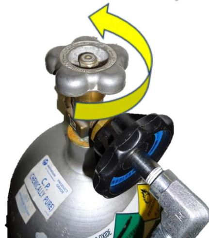
Abbildung 7: Ventil zum Öffnen gegen den Uhrzeigersinn drehen
