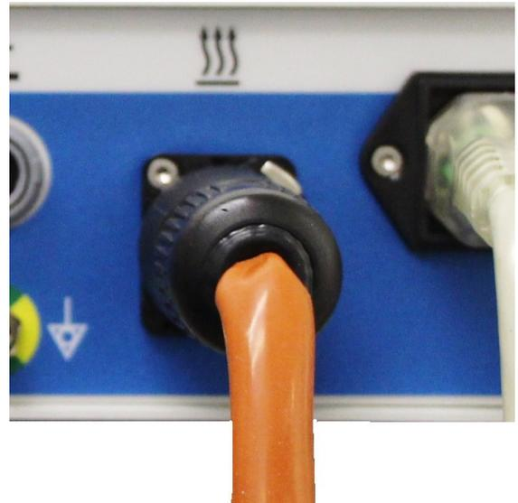
Abbildung 10: Heizmattenkabel in die Buchse stecken
