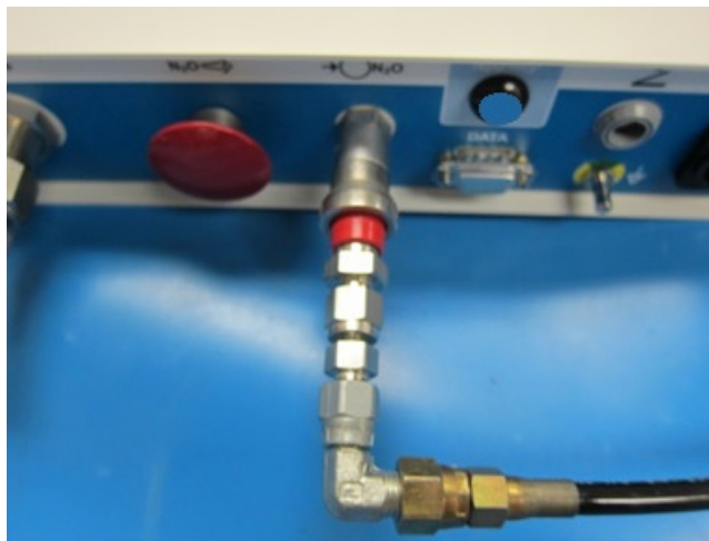
Obrázek 5: Připojení přívodu N_2O
