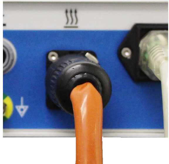
Obrázek 9: Upevnění všech napínacích pružinových úchytnů Obrázek 10: Připojení kabelu ohřívacího pásu do zdiřky
