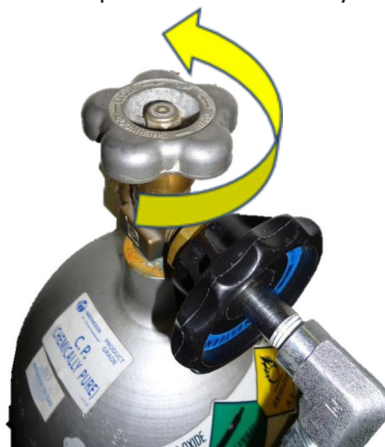
Obrázek 7: Otevření ventilu otočením proti směru hodinových ručiček
