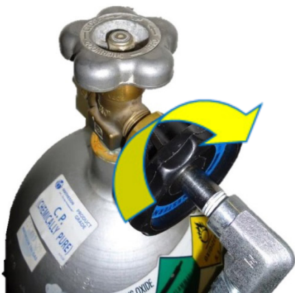
Рис. 6. Подключение черной ручки к резьбовому соединению
