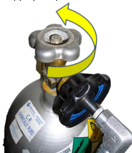
Рис. 7. Для открытия поверните вентиль против часовой стрелки
