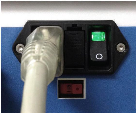
Рис. 11. Включение модуля AtriCure Cryo с помощью выключателя
