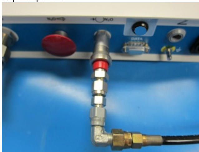
Рис. 5. Подключение впускного соединителя N_2O
