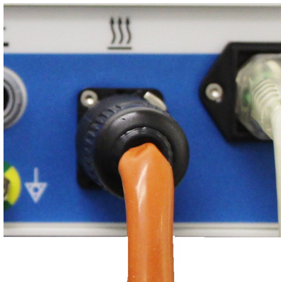
Рис. 10. Вставьте кабель ленточного нагревателя в гнездо
