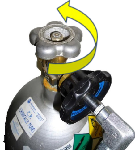
Şekil 7: Valfi Saat Yönünün Tersine Çevirerek Açın
