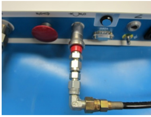
Şekil 5: N 2 O Giriş Bağlantısı
