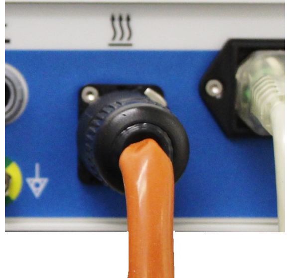
Şekil 10: Isıtıcı Bant Kablosunu Yuvaya Takın
