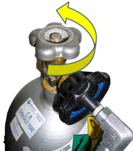
Figur 7: Vrid ventilen moturs tills den öppnas
