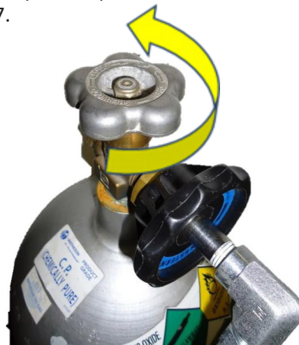
Figura 7: Rode a válvula no sentido contrário ao dos ponteiros do relógio para abrir
