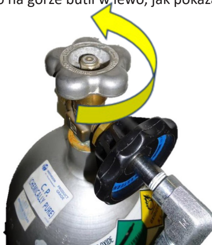
Rysunek 7: Obracanie zaworu w lewo w celu otwarcia
