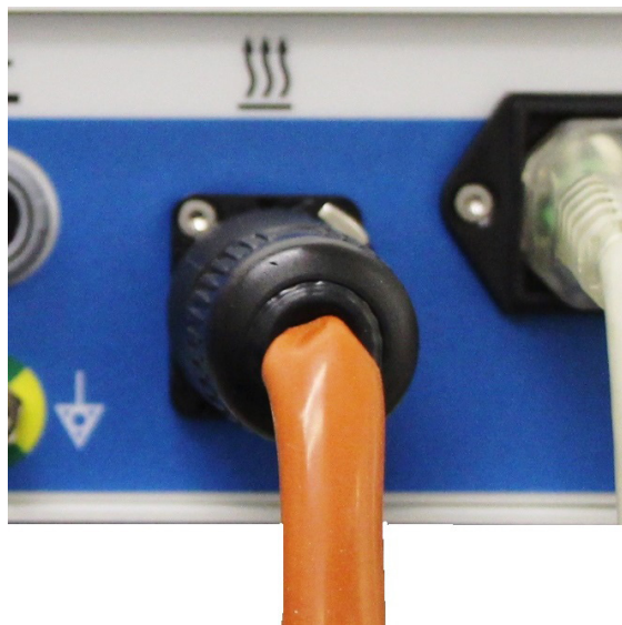
Rysunek 10: Podłączanie przewodu opaski grzejnej do gniazdka
