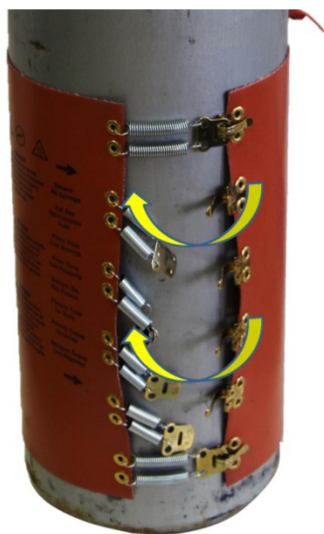
Rysunek 9: Mocowanie wszystkich napinających blokad sprężynowych
