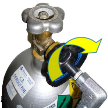
Rysunek 6: Mocowanie pokrętła do połączenia gwintowanego
