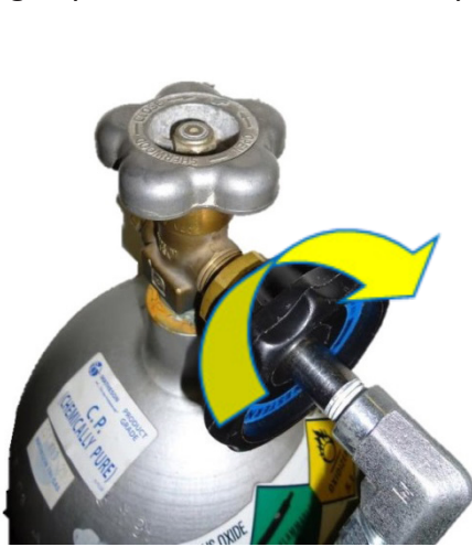
Figur 6: Fest den svarte bryteren i den gjengede koblingen
