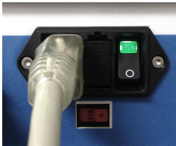
Figura 11: Accensione del modulo AtriCure cryo con interruttore
