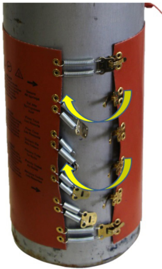
Figura 9: Blocco di tutti i fermi a molla di tensionamento
