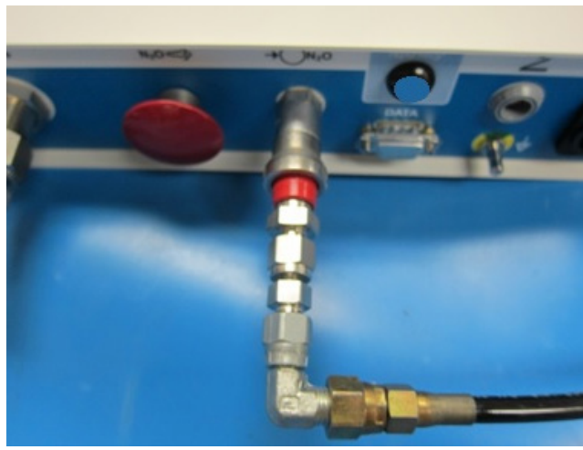
Figura 5: Collegamento di ingresso N 2 O
