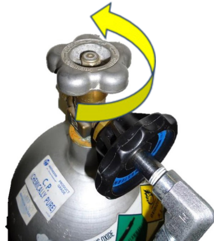
Figura 7: Rotazione della valvola in senso antiorario per aprire
