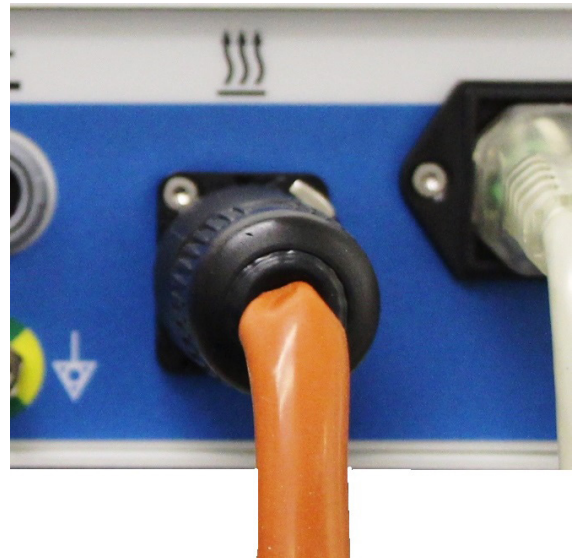
Figure 10 : brancher le cordon d'alimentation de la bande chauffante dans la prise
