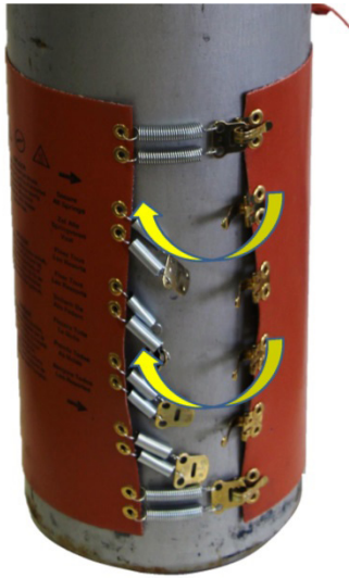
Kuva 9. Kiinnitä kaikki kiristysjouset
