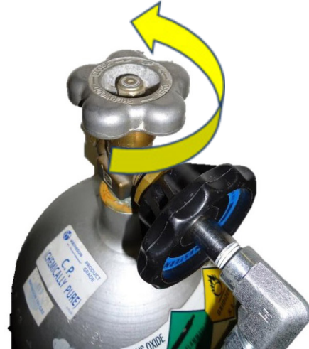
Kuva 7: Avaa venttiili kääntämällä sitä vastapäivään
