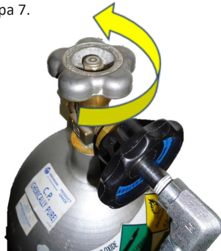
Фигура 7: Завъртете вентила обратно на часовниковата стрелка, за да се отвори
