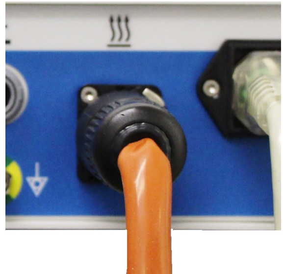
Фигура 10: Включете кабела на нагревателя в буква
