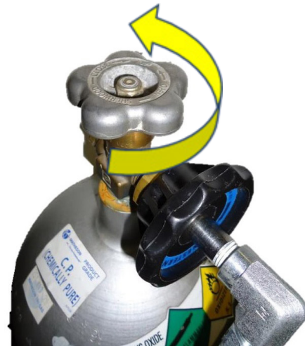
Εικόνα 7: Γυρίστε τη βαλβίδα αριστερόστροφα για να την ανοίξετε
