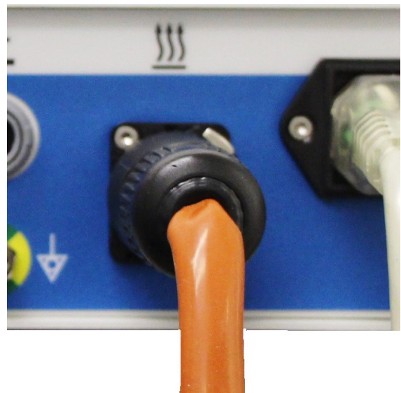
Εικόνα 10: Συνδέστε το καλώδιο της θερμαντικής ταινίας στην υποδοχή
