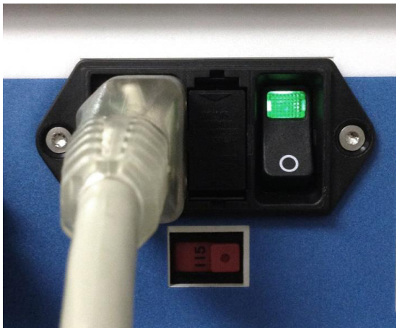
Εικόνα 11: Ενεργοποιήστε τη μονάδα AtriCure Cryo με διακόπτη
