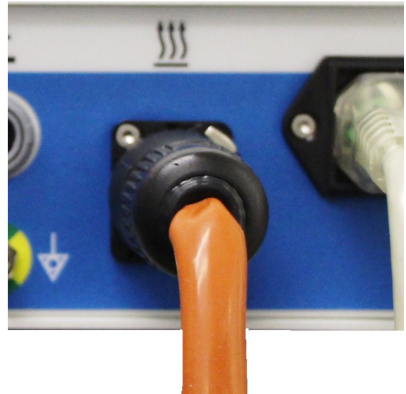
Joonis 10. Soojenduslinde juhtme pesasse ühendamine
