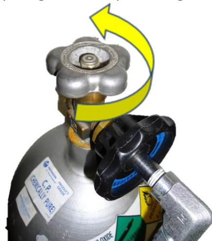
Joonis 7. Ventiili avamine seda vastupäeva keerates
