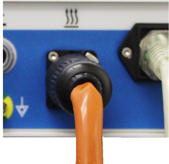
Slika 10: Priključivanje kabela omotača za grijanje u utičnicu
