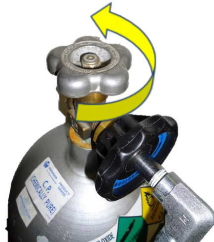
Slika 7: Otvaranje ventila okretanjem u smjeru suprotnom od kretanja kazaljke na satu
