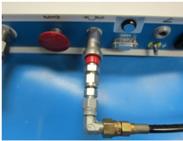
Slika 5: Priklučivanje dovoda N 2 O
