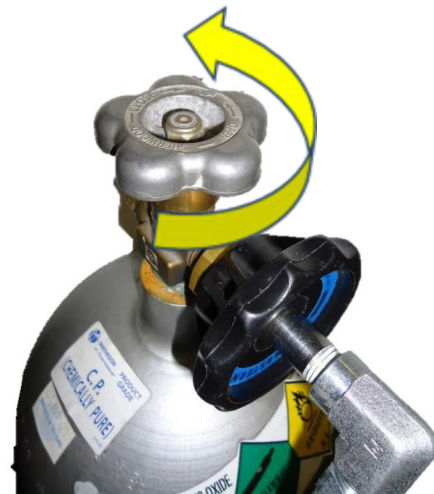
7 pav. Kad atidarytumėte, sukite čiaupą prieš laikrodžio rodyklę
