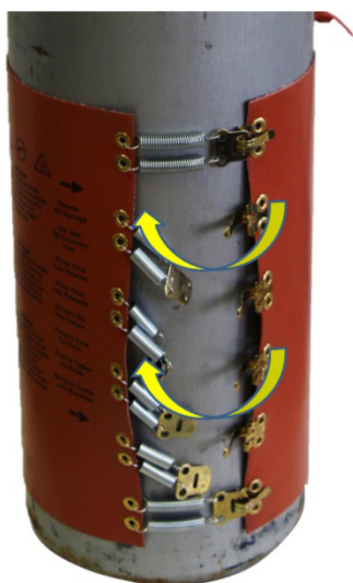
9 pav. Pritvirtinkite visus įtempiamuosius spyruoklinius laikiklius 10 pav. Įjunkite šildytuvo juostos laidą į lizdą
