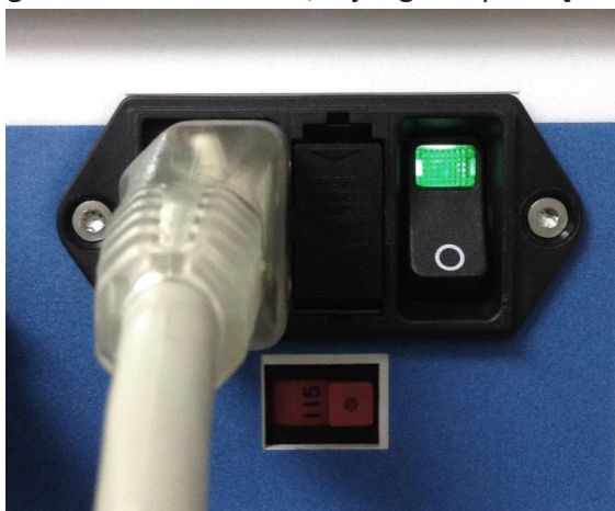
11 pav. Modulio „AtriCure Cryo“ įjungimas jungikliu
