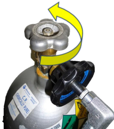
7. attēls. Lai atvērtu vārstu, pagrieziet to pretēji pulksteņrādītāju kustības virzienam
