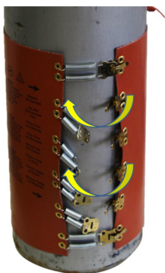
9. attēls. Nostipriniet visus spriegošanas atsperu fiksatorus 10. attēls. Iespraudiet sildelementa vadu kontaktligzdā
