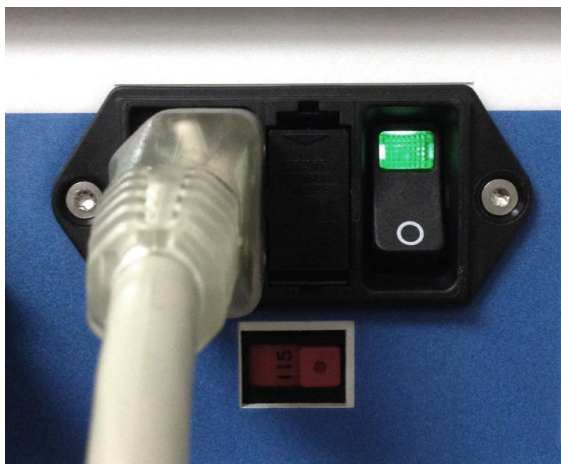
11. attēls. AtriCure Cryo moduļa ieslēgšanai izmantojiet slēdzi
