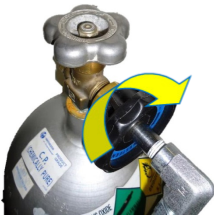
Figura 6: Montați butonul negru în conectorul filetat
