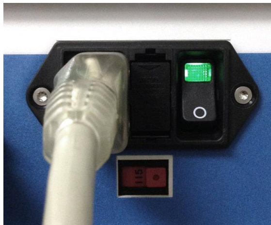
Figura 11: Ndizeni modulën "AtriCure Cryo" me anë të çelësit
