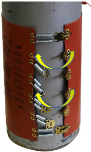
Figura 9: Siguroni të gjithë mbajtësit e sustave tendosëse Figura 10: Futni në prizë kabllon e shiritit të ngrohësit
