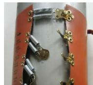
4. Retire la banda calefactora del cilindro de N<sub>2</sub>O
