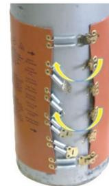
5. Sustitúyalo por un cilindro lleno y vuelva a conectar la banda calefactora
