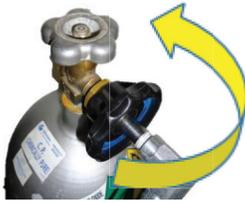
**6. Abra la válvula del tanque de N<sub>2</sub>O**
