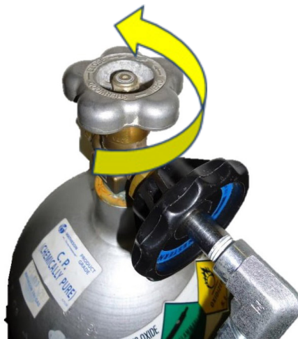
6. ábra: A szelep elfordítása balra a kinyitáshoz
