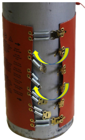
8. ábra: Az összes feszítőrugó rögzítése
