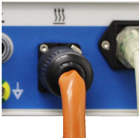
9. ábra: Dugja a fűtőszalag vezetékének dugóját az aljzatba
