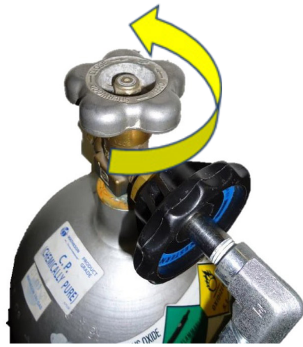
6. ábra: A szelep elfordítása balra a kinyitáshoz
