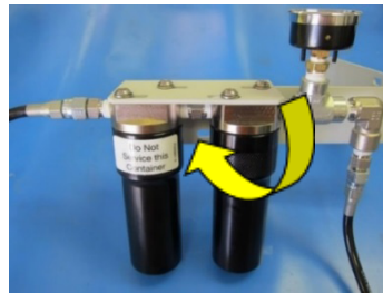
23. ábra: Szűrőház leszerelése
