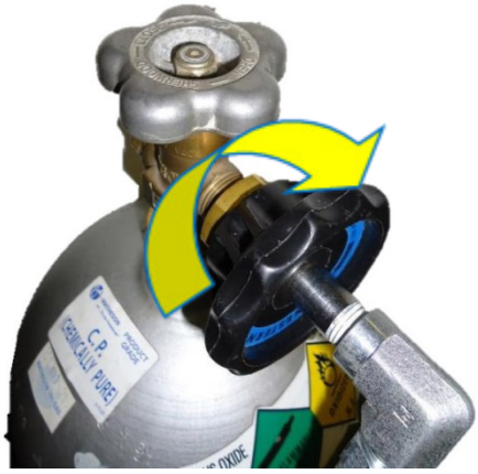
5. ábra: A fekete tárcsás vég rögzítése a menetes csatlakozón
