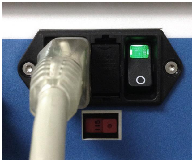
Slika 10: Uključivanje jedinice AtriCure cryoICE BOX prekidačem
