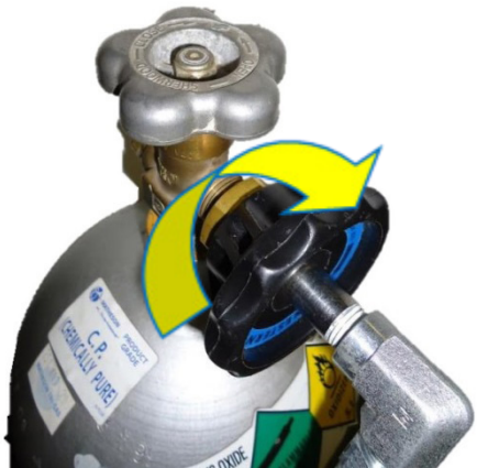
Slika 5: Priključite crno okretno dugme na navojni priključak
