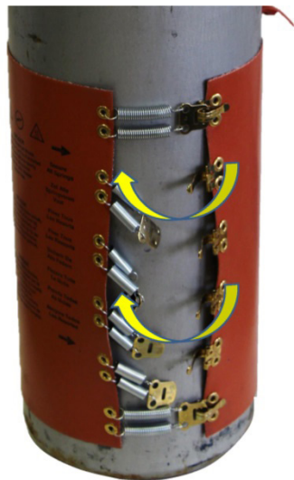
Slika 8: Pričvrstite sve zatezne opružne držače
