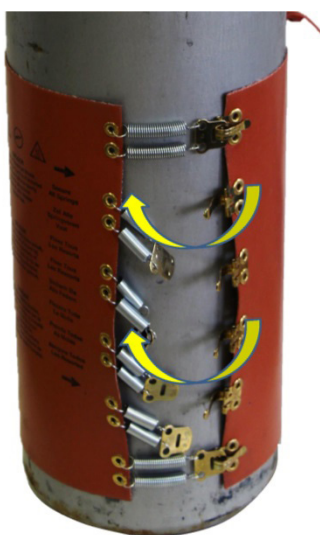
9. ábra: Az összes feszítőrugó rögzítése
