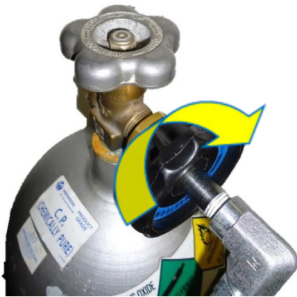
6. ábra: A fekete tárcsás vég rögzítése a menetes csatlakozón
