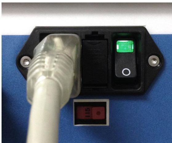
11. ábra: Az AtriCure Cryo modul bekapcsolása a kapcsolóval
