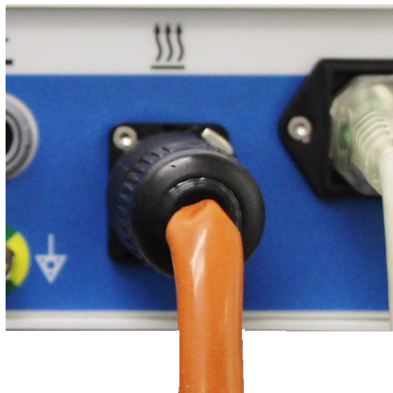
10. ábra: Dugja a fűtőszalag vezetékének dugóját az aljzatba
