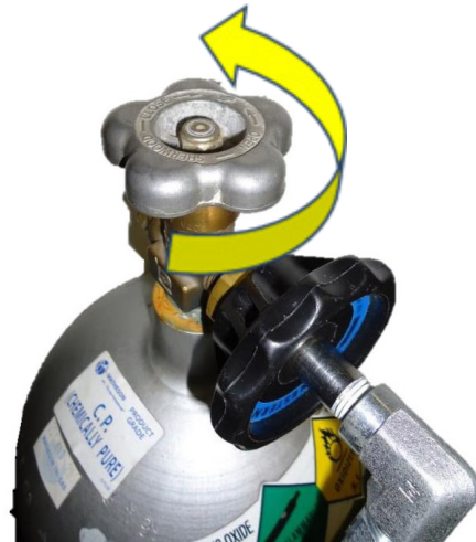
7. ábra: A szelep elfordítása balra a kinyitáshoz
