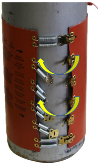
Slika 9: Pričvrstite sve zatezne opružne držače
