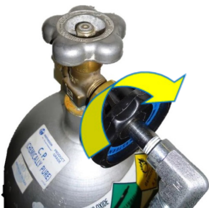
Slika 6: Priključite crno okretno dugme na navojni priključak
