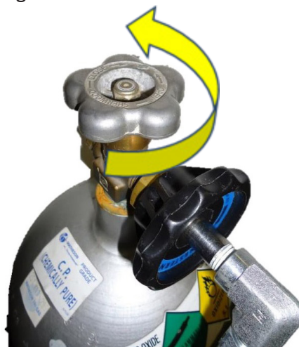
Slika 7: Okrenite ventil u smeru suprotnom od kretanja kazaljke na satu da biste ga otvorili
