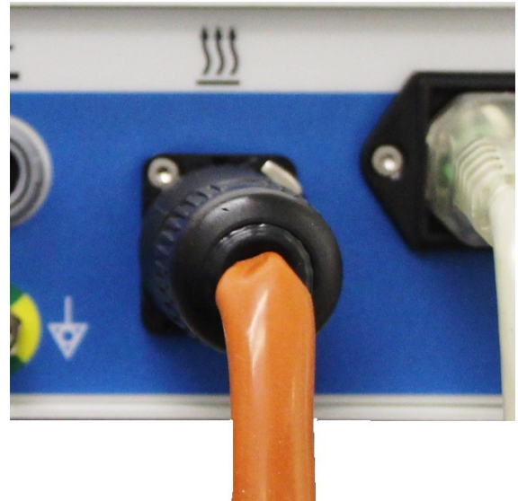
Slika 10: Priključite kabl trakastog grejača u utičnicu
