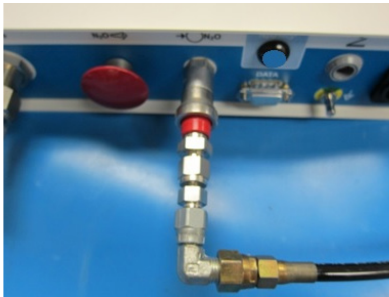
Figura 4: Conexão de entrada de N_2O
