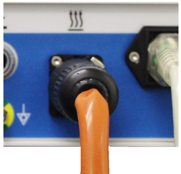
Figura 9: Conecte o cabo da banda de aquecimento na tomada
