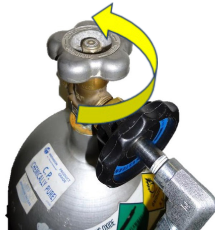
Figura 6: Gire a válvula no sentido anti-horário para abrir
