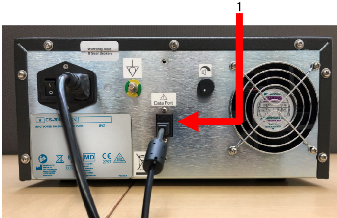
AFBEELDING 12: ACHTERPANEEL VAN DE nContact CS-3000 RF-GENERATOR MET DATAPOORT (USB) (AFBEELDING UITSLUITEND TER REFERENTIE)
