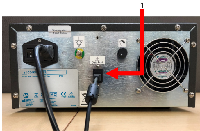
ABBILDUNG 12: RÜCKSEITE DES nContact CS-3000 HF-GENERATORS MIT DATENANSCHLUSS (USB) (BILD NUR ZUR REFERENZ)
