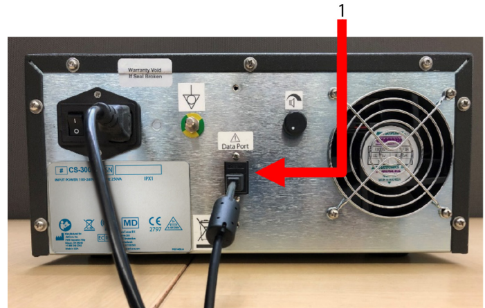
ΕΙΚΟΝΑ 12: ΠΙΣΩ ΤΑΜΠΛΟ ΓΕΝΝΗΤΡΙΑΣ RF nContact CS-3000 ΜΕ ΘΥΡΑ ΔΕΔΟΜΕΝΩΝ (USB) (Η ΕΙΚΟΝΑ ΕΙΝΑΙ ΜΟΝΟ ΓΙΑ ΑΝΑΦΟΡΑ)
