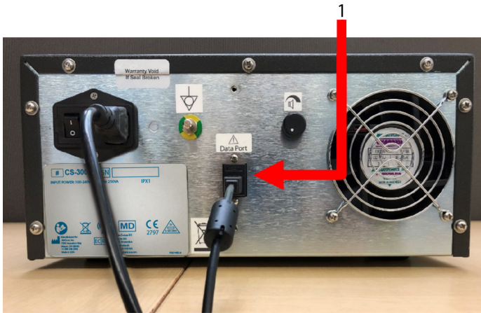
FIGURA 12: PANEL TRASERO DEL GENERADOR DE RF CS-3000 DE nContact CON PUERTO DE DATOS (USB) (IMAGEN SOLO PARA REFERENCIA)
