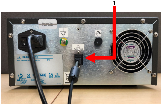
ФИГУРА 12: ЗАДЕН ПАНЕЛ НА РЧ ГЕНЕРАТОР CS-3000 nContact С ПОРТ ЗА ДАННИ (USB) (ИЗОБРАЖЕНИЕТО Е САМО ЗА СПРАВКА)
