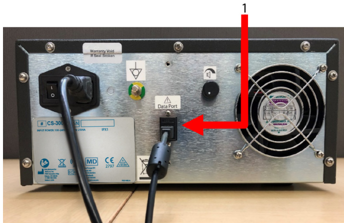
FIGURA 12: PAINEL TRASEIRO DO GERADOR DE RF nContact CS-3000 COM PORTA DE DADOS (USB) (IMAGEM APENAS PARA REFERÊNCIA)
