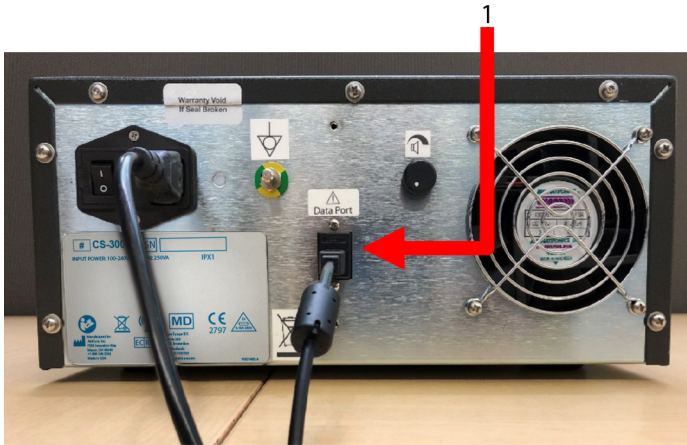
FIGUR 12: nContact CS-3000 RF-GENERATORENS BAKPANEL MED DATAPORT (USB) (BILDE KUN SOM REFERANSE)
