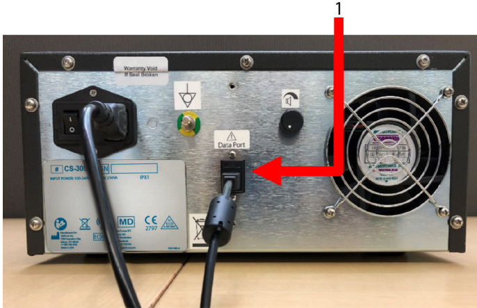
SLIKA 12: ZADNJA PLOŠČA RF-GENERATORJA nContact CS-3000 S PODATKOVNIMI VRATI (USB) (SLIKA SAMO ZA REFERENCO)
