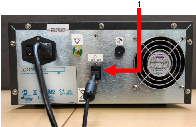
FIGURA 12: PANOUL DIN SPATE AL GENERATORULUI DE RF nContact CS-3000 CU PORT DE DATE (USB) (IMAGINE DOAR PENTRU REFERINȚĂ)
