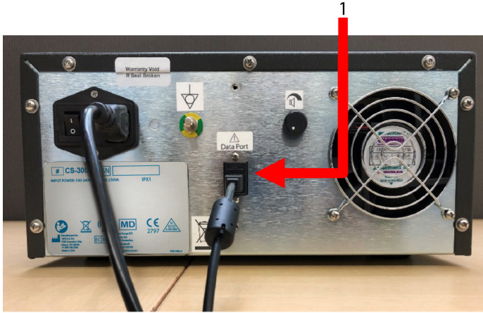
OBRAZEK 12: ZADNÍ PANEL RF GENERÁTORU nContact CS-3000 S DATOVÝM PORTEM (USB) (OBRAZEK POUZE PRO REFERENCI)
