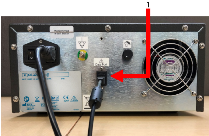
SLIKA 12: STRAŽNJA PLOČA RF-GENERATORA nContact CS-3000 S PODATKOVNIM PRIKLJUČKOM (USB) (SLIKA SLUŽI SAMO KAO ILUSTRACIJA)
