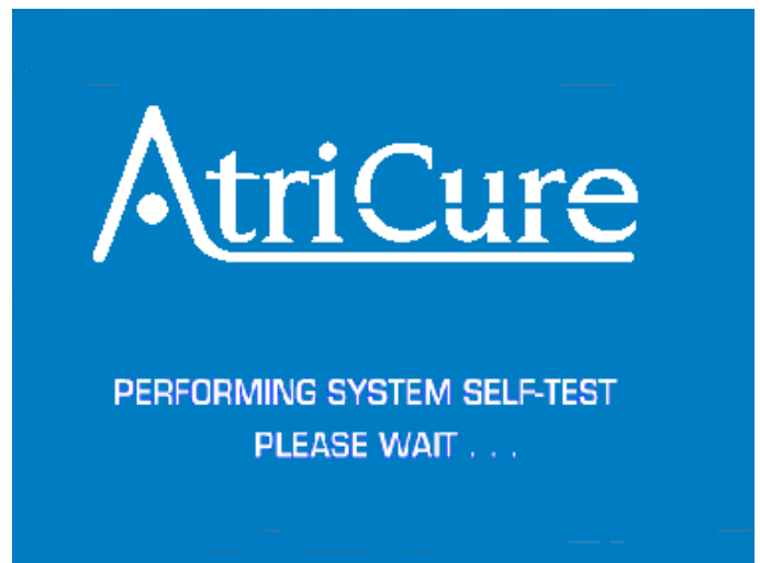
Фигура 7: Дисплей, показващ самодиагностичния тест за включване на захранването (POST)
