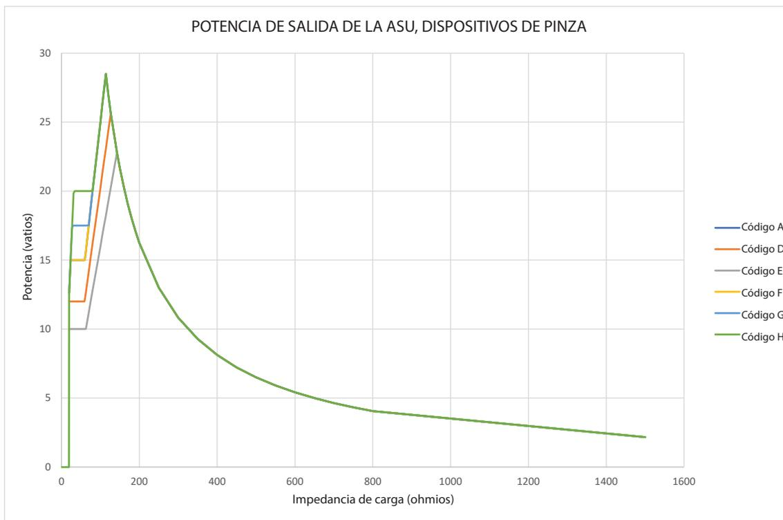
**Figura 2: comparación de potencia y carga (algoritmo de la pinza)**
