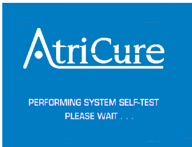
7. ábra: A kijelző a bekapcsolási önellenőrzést (POST) mutatja
