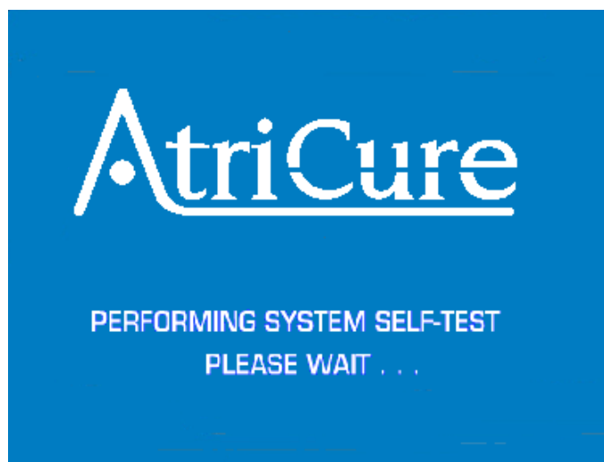
Figur 7: Display som indikerar självtest vid start (POST)
