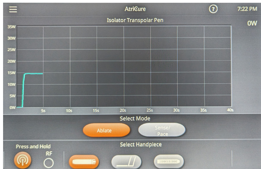
Slika 9. Zaslona za ručni instrument u obliku olovke
