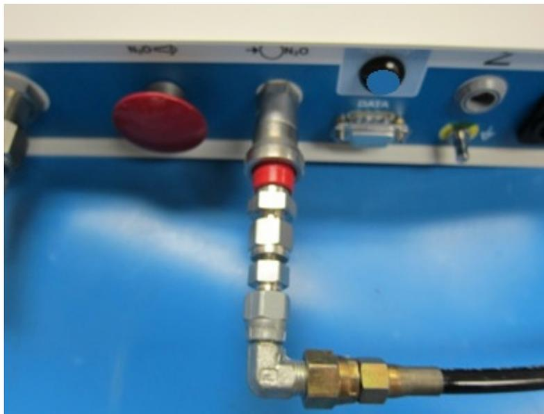
Рис. 4. Подключение впускного соединителя N<sub>2</sub>O
