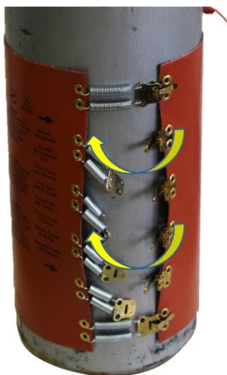
Рис. 8. Закрепите все фиксаторы пружин натяжения
