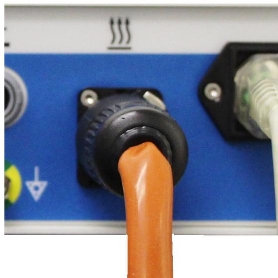
Рис. 9. Вставьте кабель ленточного нагревателя в гнездо
