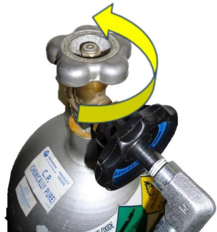
Рис. 6. Для открытия поверните вентиль против часовой стрелки
