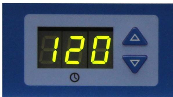
Рис. 17. Дисплей времени абляции
