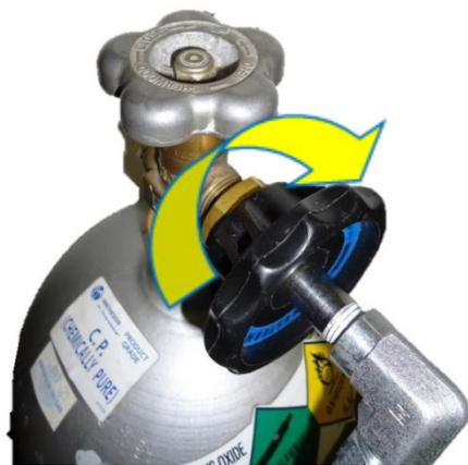
Рис. 5. Подключение черной ручки к резьбовому соединению
