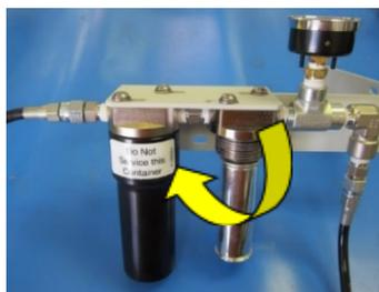
Рис. 24. Снятие картриджа фильтра осушителя
