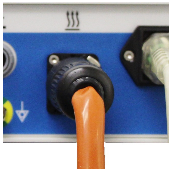
Рис. 9. Вставьте кабель ленточного нагревателя в гнездо
