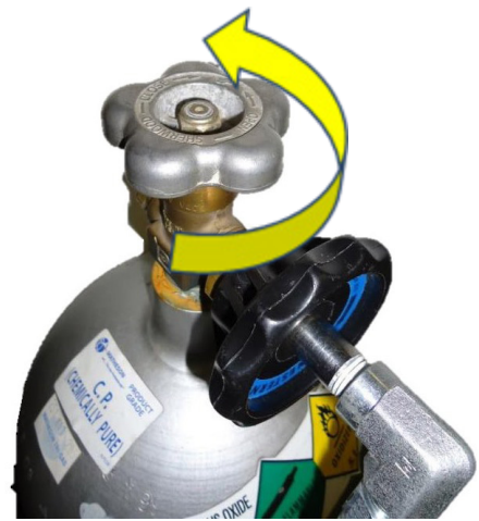
Рис. 6. Для открытия поверните вентиль против часовой стрелки
