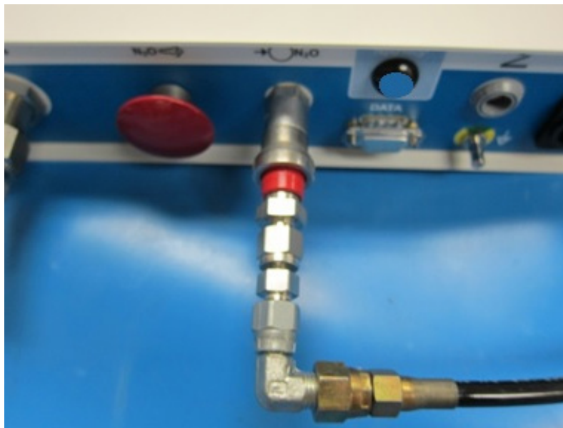
Рис. 4. Подключение впускного соединителя N 2 O
