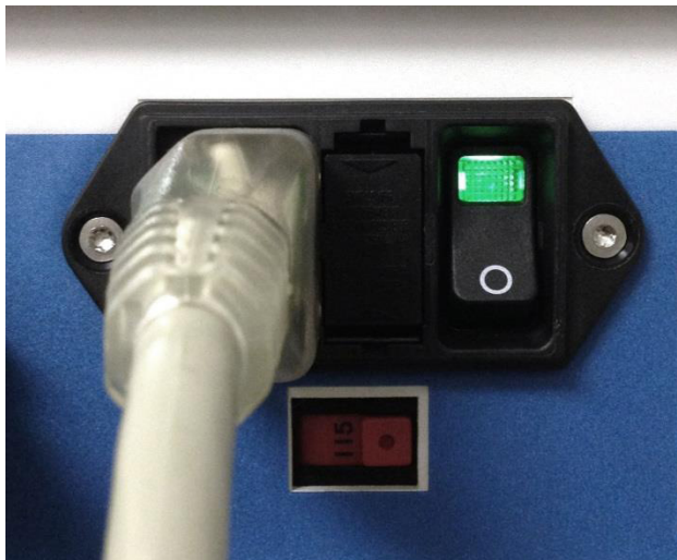
Рис. 10. Включение прибора AtriCure cryoICE BOX с помощью выключателя
