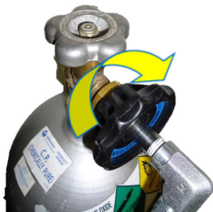
Рис. 5. Подключение черной ручки к резьбовому соединению
