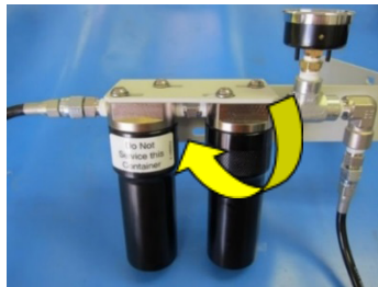
Рис. 23. Снятие корпуса фильтра
