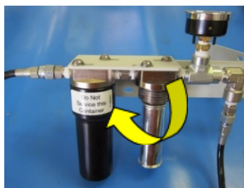
Рис. 24. Снятие картриджа фильтра осушителя
