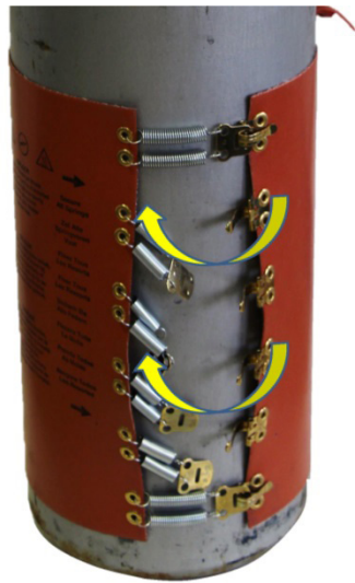
Abbildung 8: Alle Spannfederhalterungen sichern
