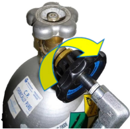
Abbildung 5: Schwarzen Knopf am Gewindeanschluss anbringen
