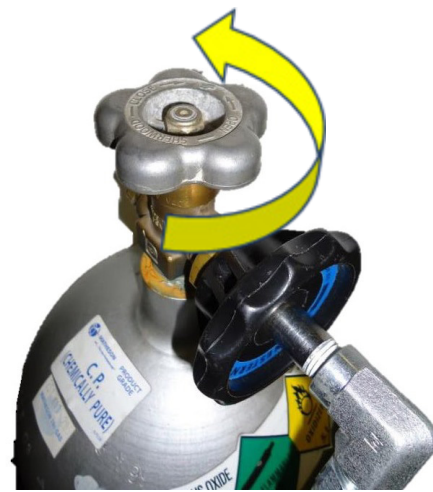
Abbildung 6: Ventil zum Öffnen gegen den Uhrzeigersinn drehen
