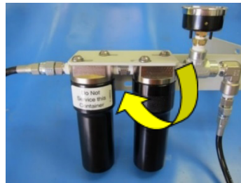
Abbildung 23: Entfernen des Filtergehäuses
