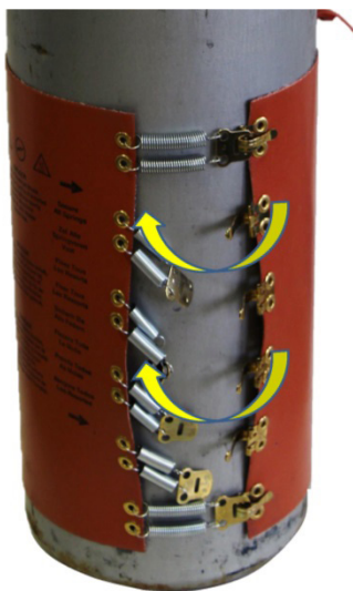
Afbeelding 8: Alle veerspanningsbevestigingen vastmaken
