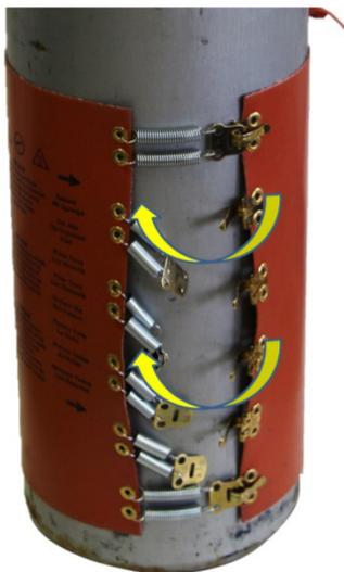
Figura 8: Blocco di tutti i fermi a molla di tensionamento
