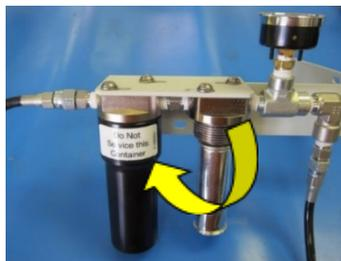
*Figura 24: Rimozione della cartuccia del filtro essiccante*
