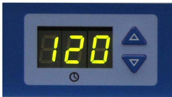
Figura 17: Display del tempo dell'ablazione
