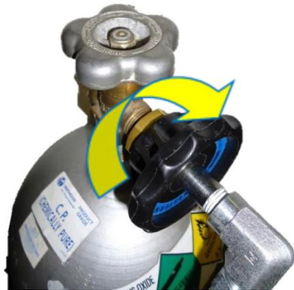
Figura 5: Collegamento della manopola nera alla connessione filettata
