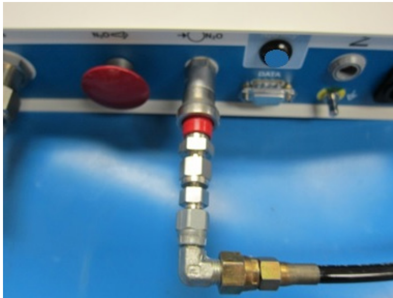
Figura 4: Collegamento di ingresso N 2 O
