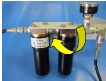
Figura 23: Rimozione dell'alloggiamento del filtro
