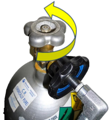
Figura 6: Rotazione della valvola in senso antiorario per aprire
