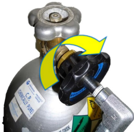
Figura 5: Collegamento della manopola nera alla connessione filettata
