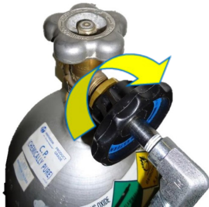
Figure 5 : fixez la molette noire au raccord fileté
