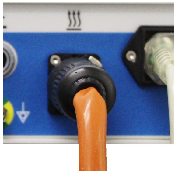
Figure 9 : branchez le cordon d'alimentation de la bande chauffante dans la prise
