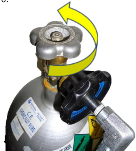
Figure 6 : tournez la vanne dans le sens anti-horaire pour l'ouvrir
