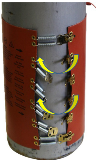
Figure 8 : fixez tous les dispositifs de maintien à ressorts tenseurs
