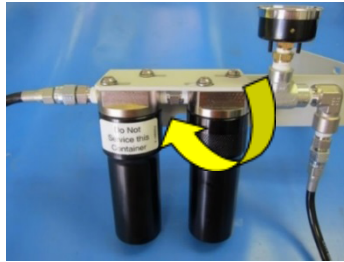
Figure 23 : retrait du boîtier de filtre
