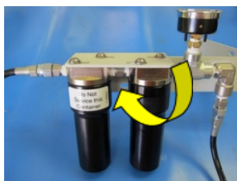
Obrázek 23: Sejmutí pouzdra filtru
