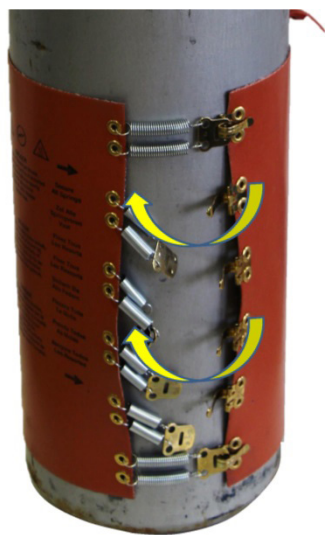
Obrázek 8: Upevnění všech napínacích pružinových úchyťů
