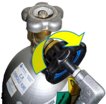
Obrázek 5: Připojení černého otočného kolečka k závitovému spoji
