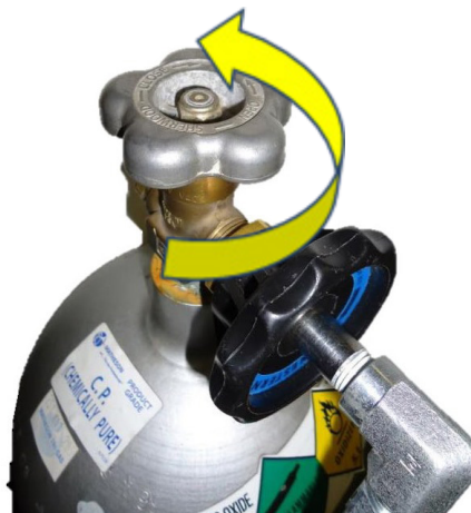
Obrázek 6: Otevření ventilu otočením proti směru hodinových ručiček
