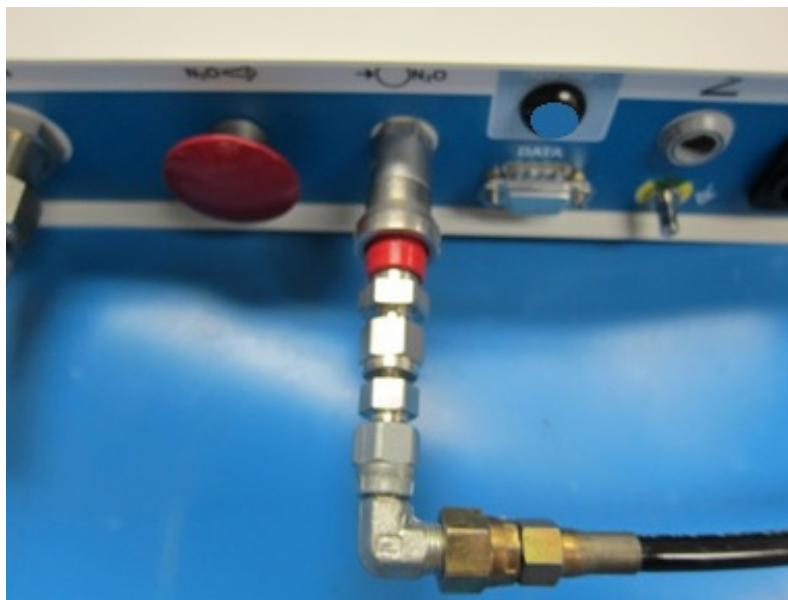
Obrázek 4: Připojení přívodu N_2O
