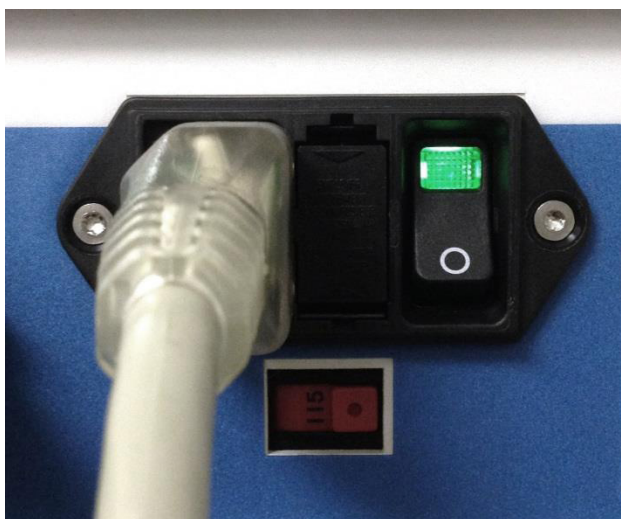
Figur 10: Slå på AtriCure cryoICE BOX med bryter
