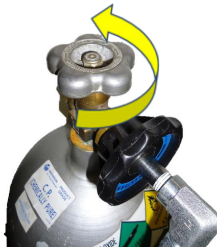
Figur 6: Vri ventilen mot klokka for å åpne
