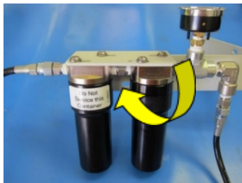
Figur 23: Fjerning av filterhus
